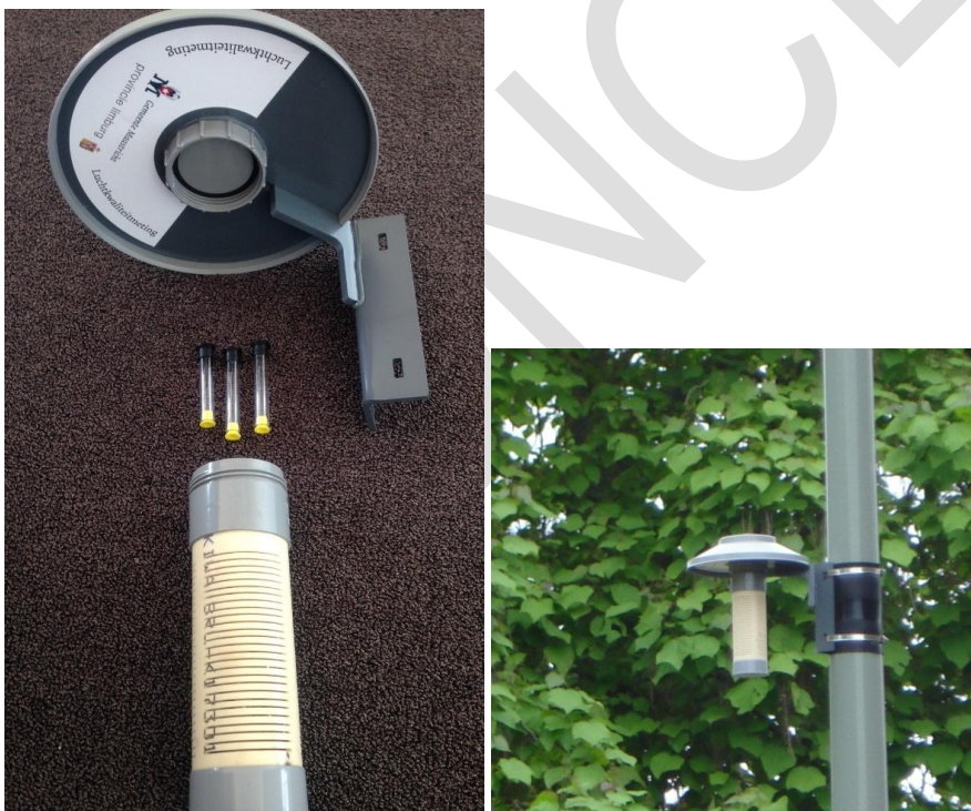
Figuur 6: Diffusiebuisjes en houder zoals gebruikt voor het onderzoek van 2014-2015: Diffusiebuisje, gesloten en open, (tijdens gebruik wordt alleen het gele dopje verwijderd); de diffusiebuisjes en de open houder; en de houder aan een lantaarnpaal.
