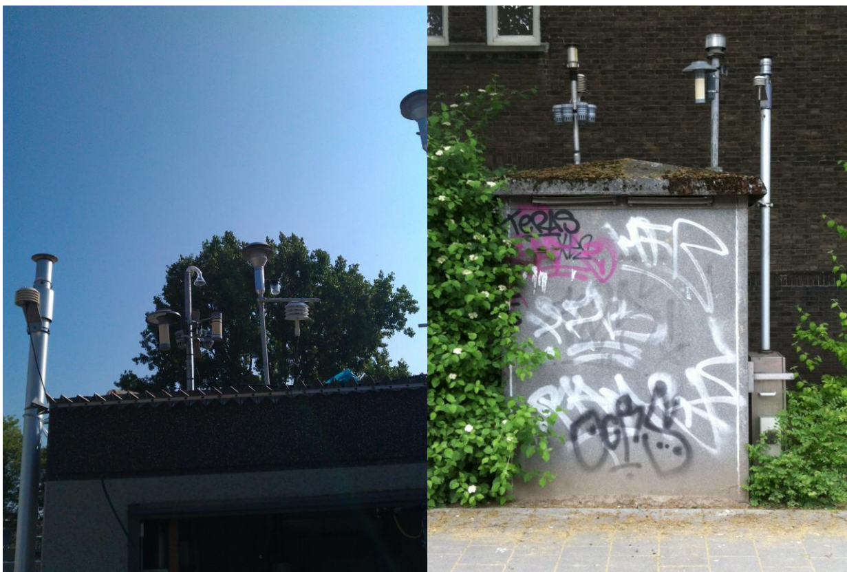
Figuur 7: diffusiebuisjes in houder bij PLIM- en RIVM meetstation
